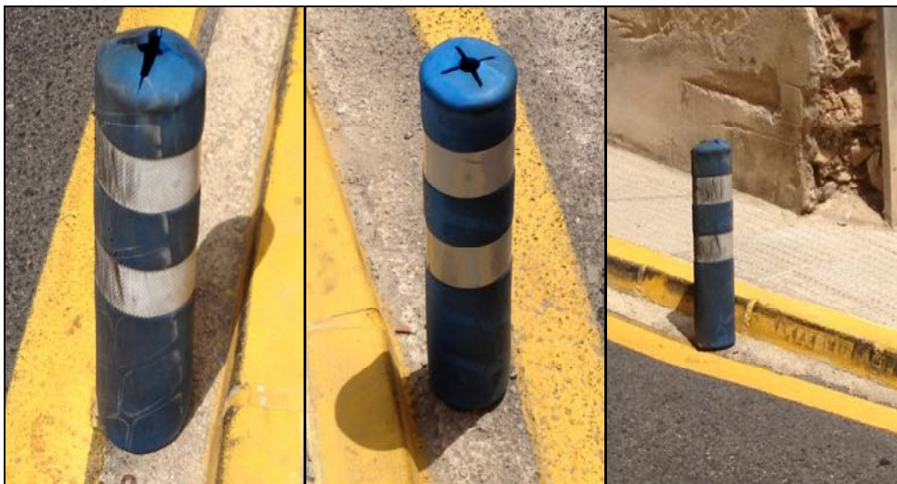
En las dos primeras imágenes se puede apreciar marcas de ruedas de vehículos pesados que han pasado por encima de las balizas. En la tercera imagen se puede apreciar que la baliza ha sido repetidamente golpeada. Tomadas el 26-7-2012.
